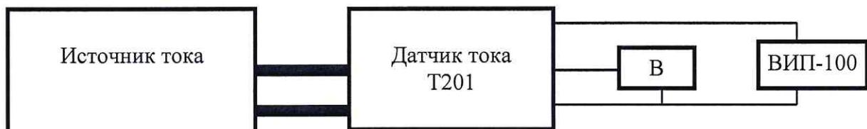
«B» - мультиметр Fluke 8845A в режиме измерения напряжения постоянного тока.
