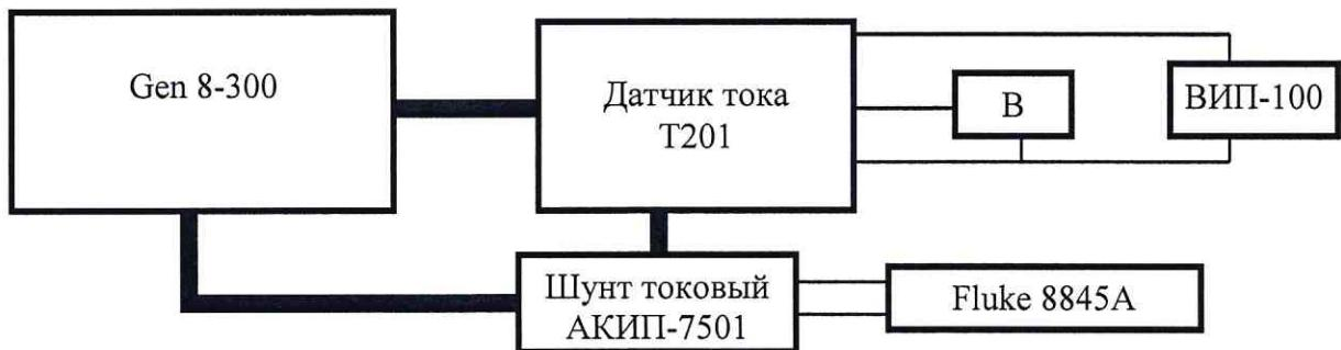
«В» - мультиметр Fluke 8845A в режиме измерения напряжения постоянного тока.
