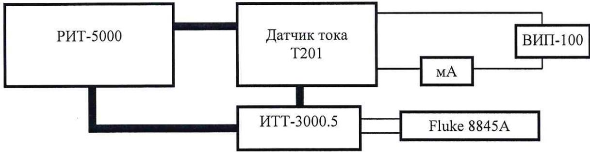
«mA» - мультиметр Fluke 8845A в режиме измерения силы постоянного тока.
