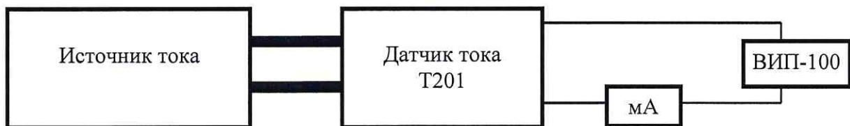
«mA» - мультиметр Fluke 8845A в режиме измерения силы постоянного тока.
