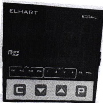
Рисунок 3 – Общий вид ECD4-L
