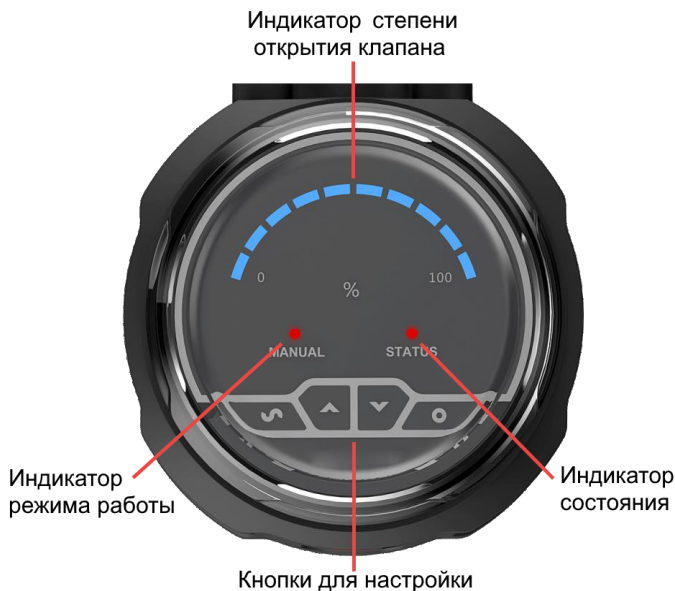
Рисунок 9 – Расположение органов управления и индикации
