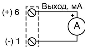
Рис. 3.13 — Подключение активного аналогового токового выхода
