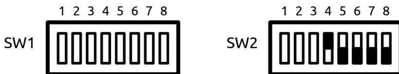
Рисунок 24 - Состояние DIP-переключателей. Режим №1, программная настройка чувствительности тензодатчика
