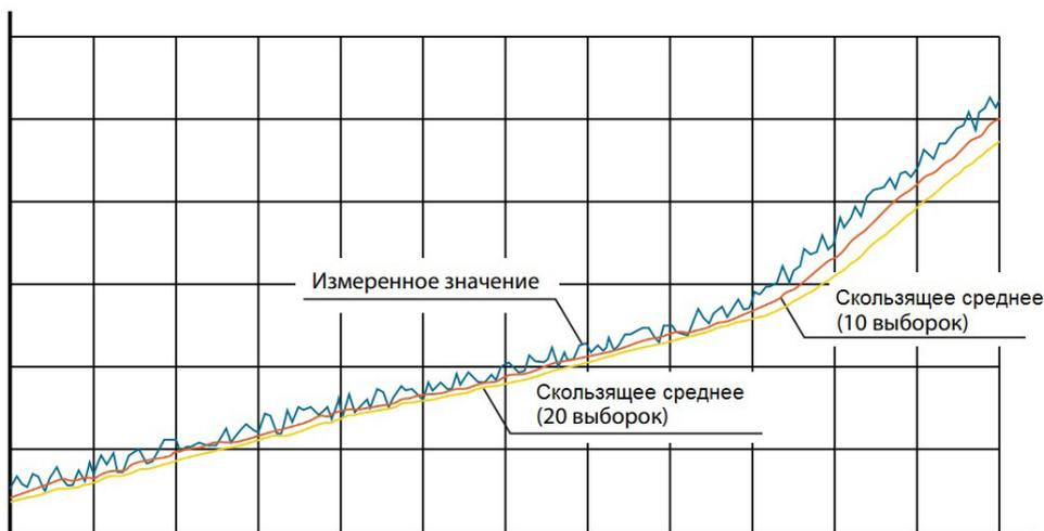
Рисунок 22 - График изменения входного сигнала при дозировании
