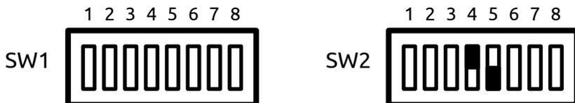
Рисунок 30 - Состояние DIP-переключателей
