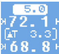
Рисунок 10.2.4 — Регулирование по разнице температур прямой и обратной воды в контуре отопления
