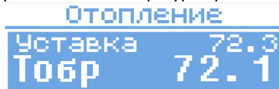
Рисунок 10.1.3 — Регулирование по температуре обратной воды в контуре отопления
