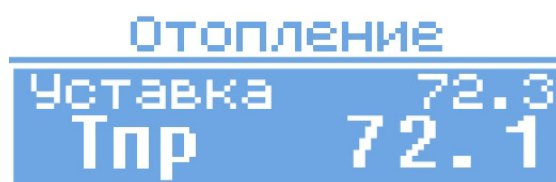
Рисунок 10.1.2 — Регулирование по температуре прямой воды в контуре отопления
