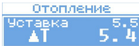
Рисунок 10.1.4 — Регулирование по разнице температур прямой и обратной воды
