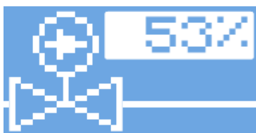
Рисунок 10.2.4 — Индикатор положения клапана
