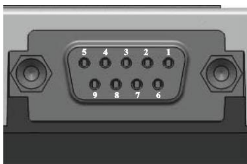
Рисунок 6: Выводы RS-232 (D-Sub 9-контактный)
