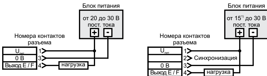
Рисунок 5 – Схема подключения датчиков skS-15/E , skS-15/CE и skS-15/CF/A (подключение по схеме с транзистором NPN)
