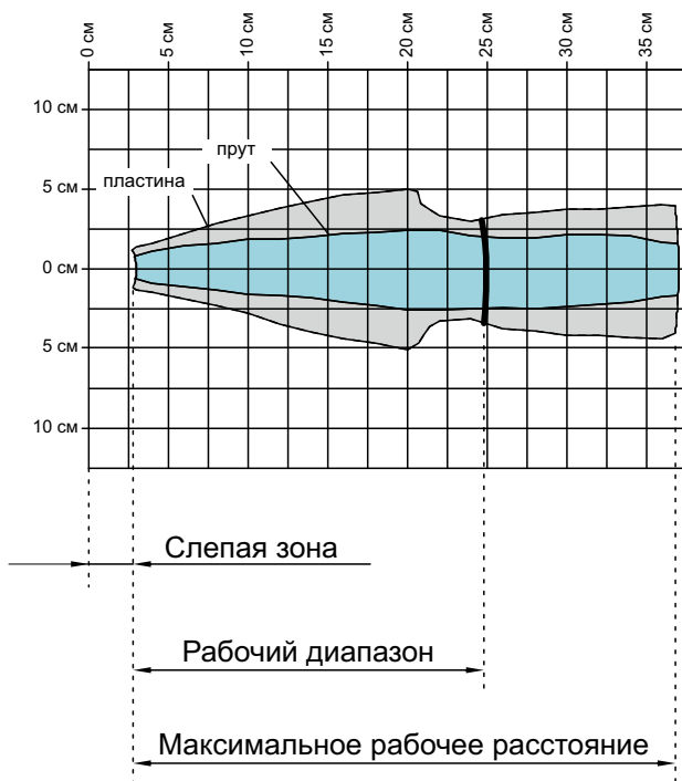
Рисунок 22 – Зона распространения ультразвуковой волны датчиков серии Ірс-25/...
