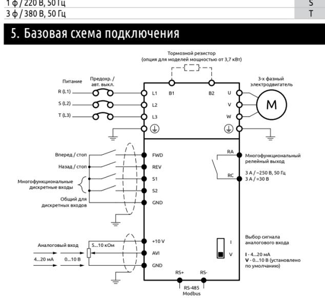
**⚠** Подключение питания к преобразователю должно осуществляться только на клеммы L1, L2, L3. Для моделей с однофазным питанием (220 В) напряжение питания подается только на клеммы L1 и L2. Напряжение питания должно соответствовать заводской этикетке преобразователя
