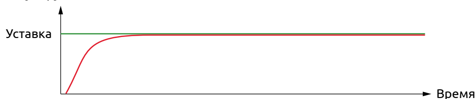
Рисунок 23 - Выход на уставку правильно настроенного ПИД-регулятора
