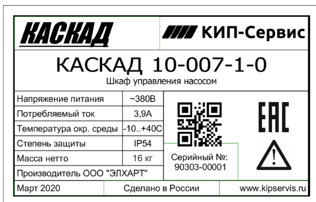
Рисунок 3.2 – Этикетка с характеристиками Шкафа управления
