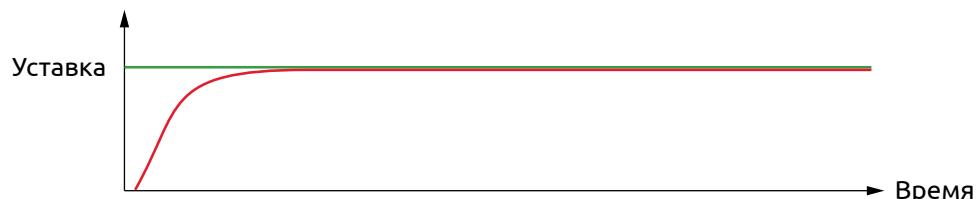
Рисунок 30 - Выход на уставку правильно настроенного ПИД-регулятора
