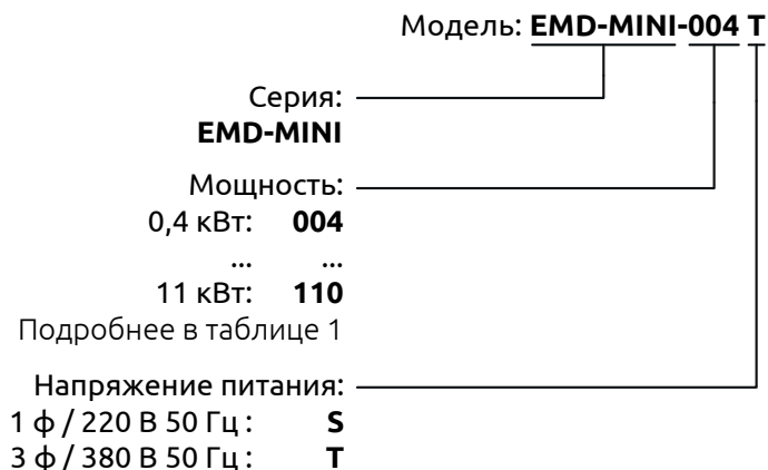
Рисунок 2 – Расшифровка обозначения модели ПЧ
