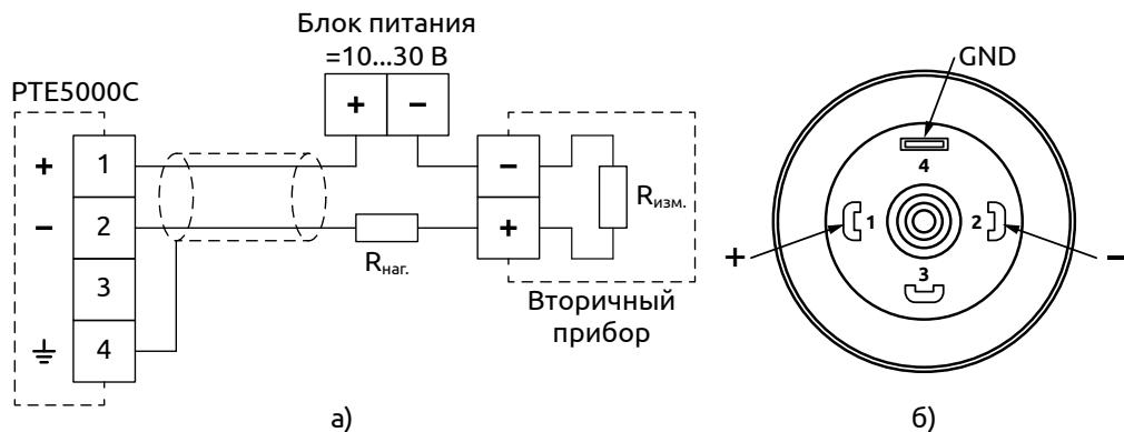
Рисунок 3 - Подключение электрических цепей датчика:
