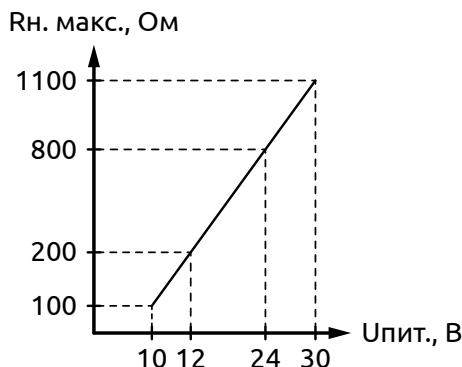
Рисунок 4 - Графическое представление зависимости максимального сопротивления токового выхода датчика ( $R_{н.макс.}$ ) от напряжения используемого источника питания (Упит.)
