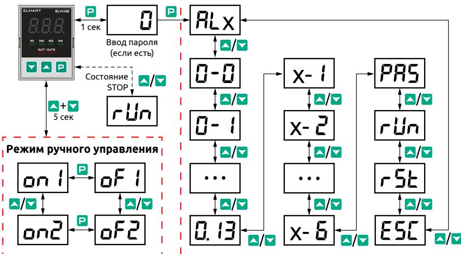
Рисунок 22 – Навигация в меню прибора
