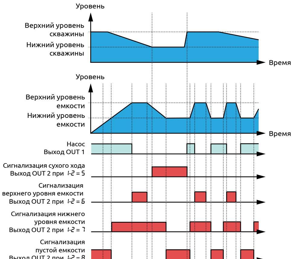
**Рисунок 44 – Временная диаграмма алгоритма 1 с сигнализацией сухого хода**
