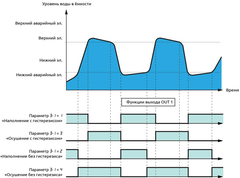
*Рисунок 31 – Временные диаграммы алгоритма 3 "Двухканальный независимый регулятор уровня"*
