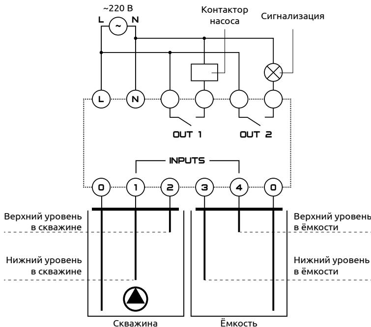
Рисунок 4 – Схема подключения для алгоритма 1 "Управление погружным насосом"
