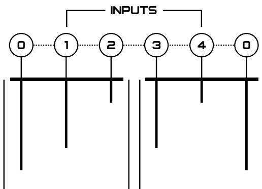
Рисунок 14 – Пример схемы подключения кондуктометрических датчиков
