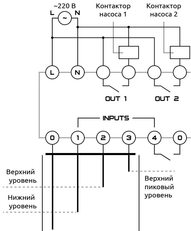
Рисунок 33 – Схема подключения для алгоритма 4
