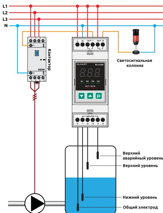
Рисунок 47 – Наполнение емкости с сигнализацией перелива
