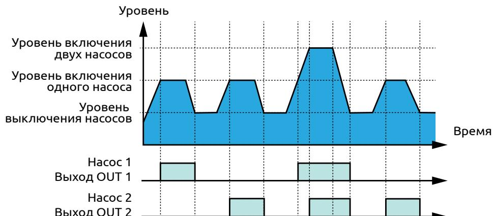
*Рисунок 63 – Временная диаграмма алгоритма 4 управления КНС*
