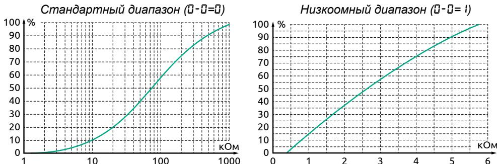
*Рисунок 23 – График настройки чувствительности входов*
