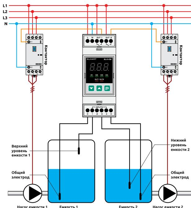
Рисунок 60 – Наполнение/осушение емкостей с гистерезисом по времени
