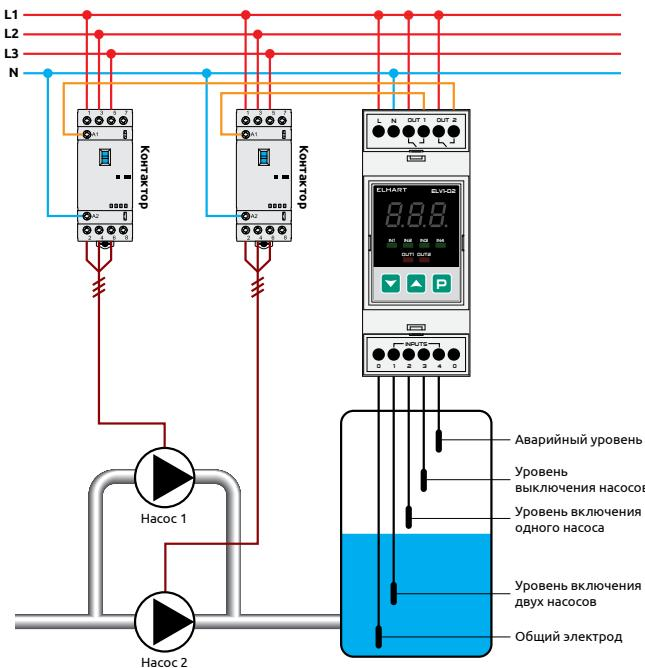
*Рисунок 67 – Наполнение емкости с чередованием насосов*
