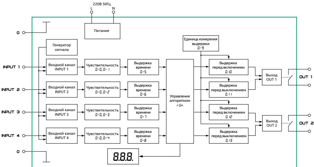
Рисунок 20 – Функциональная схема прибора
