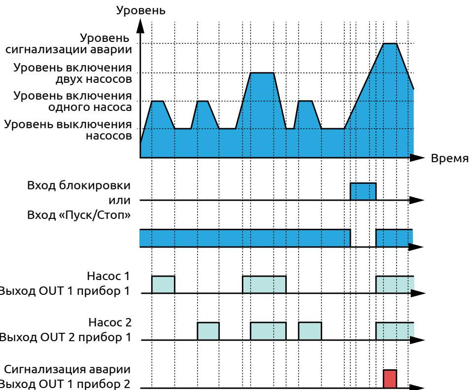
*Рисунок 66 – Временная диаграмма алгоритма 4 управления КНС с сигнализацией*
