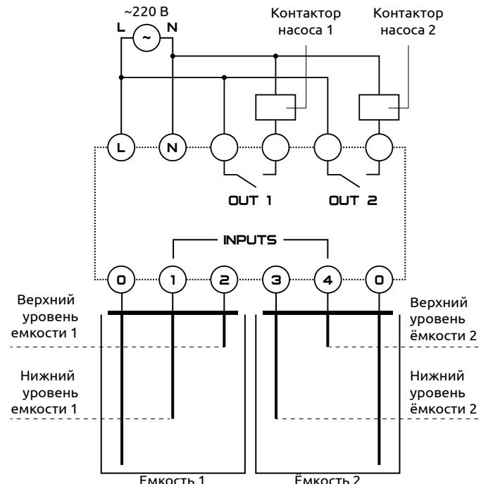
Рисунок 9 – Схема подключения для алгоритма 3
