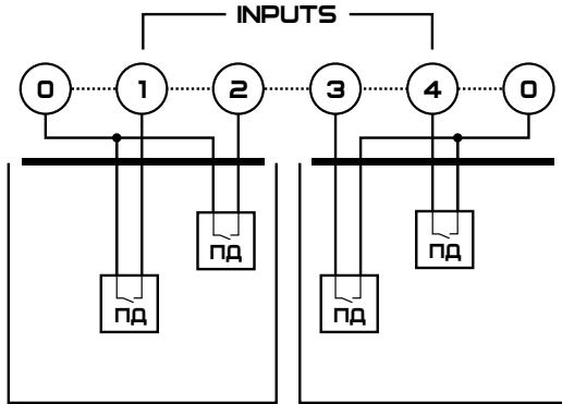
*Рисунок 15 – Пример схемы подключения поплавковых датчиков*
