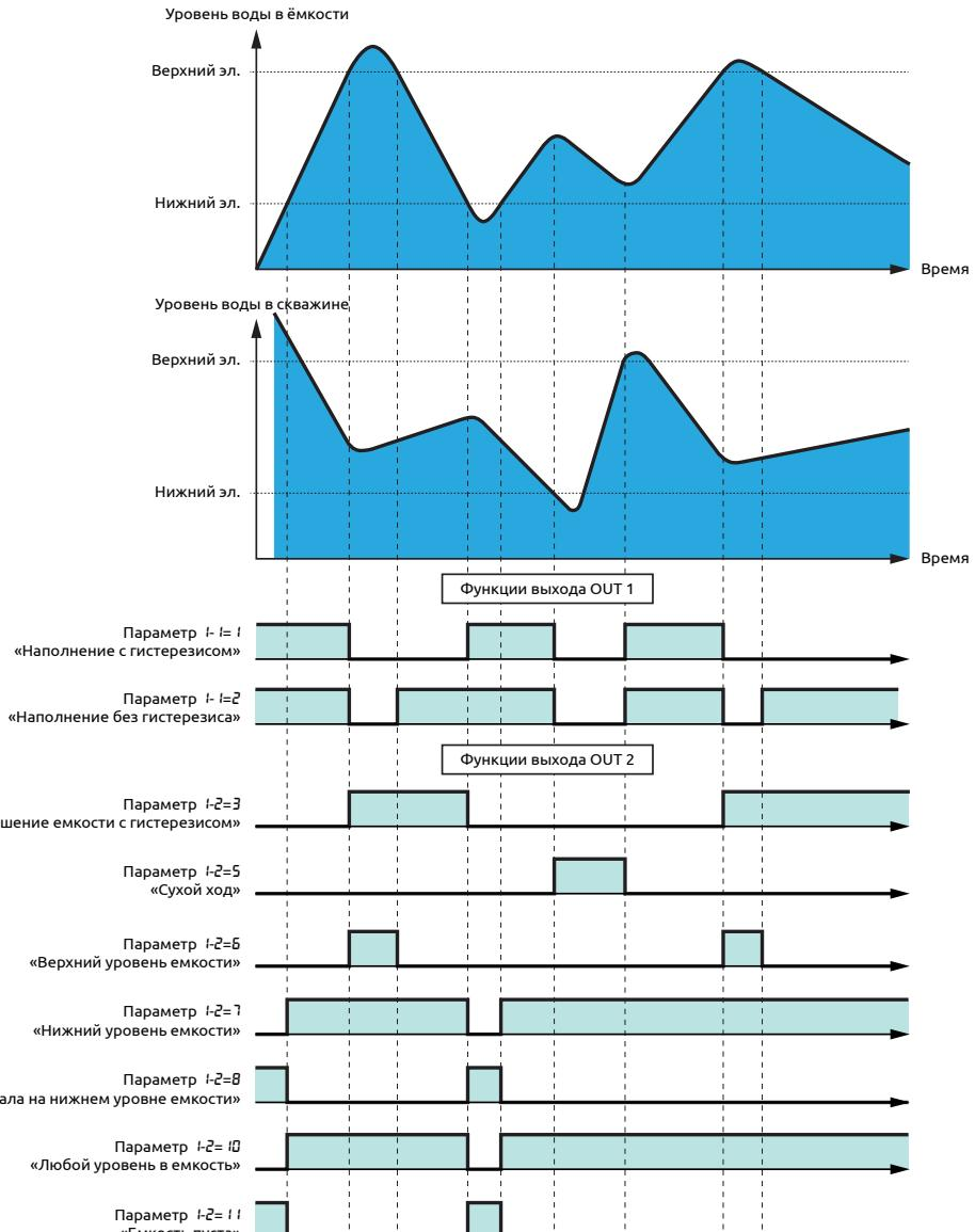
*Рисунок 25 – Временные диаграммы алгоритма 1 "Управление погружным насосом"*
