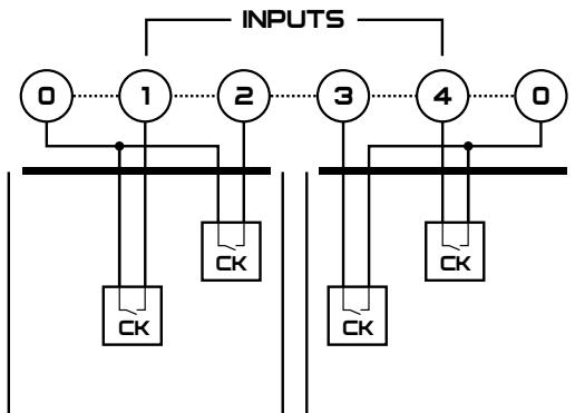
*Рисунок 16 – Пример схемы подключения входов типа "сухой контакт"*
