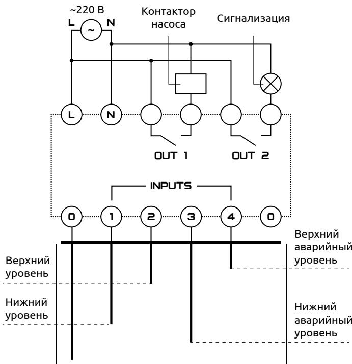
Рисунок 27 – Схема подключения для алгоритма 2
