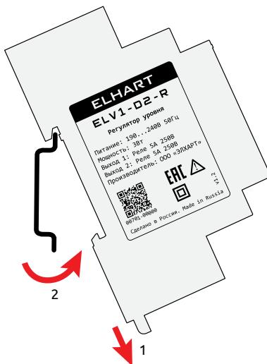
Рисунок 41 – Демонтаж прибора
