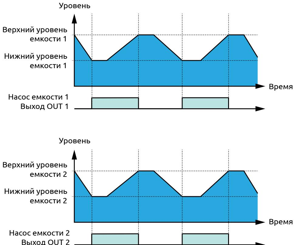
Рисунок 57 – Временная диаграмма алгоритма 2 для наполнения емкостей
