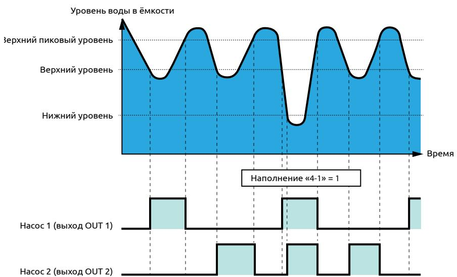
Рисунок 34 – Временные диаграммы алгоритма 4 "Управление канализационной насосной станцией"
