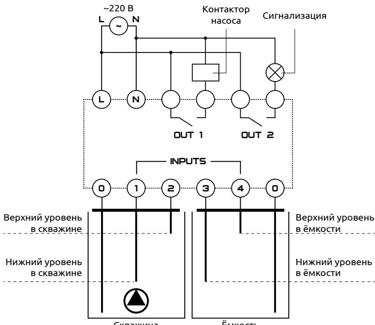
Рисунок 24 – Схема подключения для алгоритма 1
