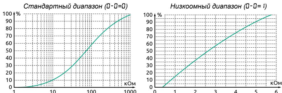
Рисунок 36 – График настройки чувствительности входов
