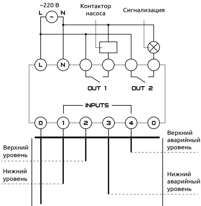
Рисунок 8 – Схема подключения для алгоритма 2 при использовании верх-него и нижнего аварийных уровней
