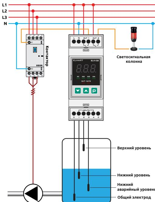
Рисунок 49 – Осушение емкости с сигнализацией сухого хода
