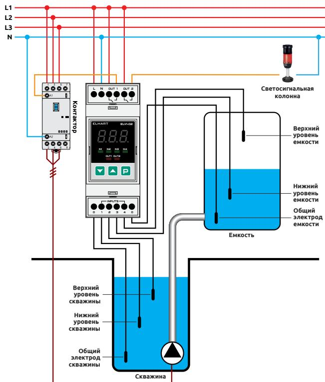
Рисунок 43 – Управление погружным насосом с сигнализацией сухого хода
