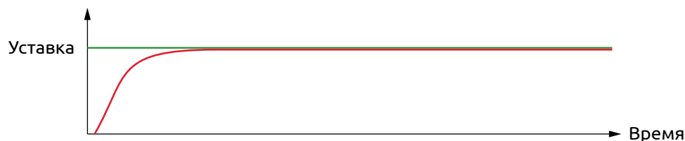
Рисунок 33 - Выход на уставку правильно настроенного ПИД-регулятора
