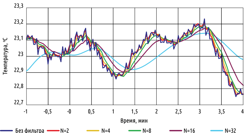
Рисунок 13 - Результат цифровой фильтрации показаний температуры (колпачок без фильтрующего материала)
