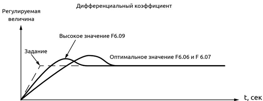
Рисунок 82 - Влияние коэффициентов регулятора на переходный процесс
