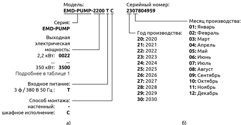
Рисунок 2 - Расшифровка обозначения модели ПЧ
