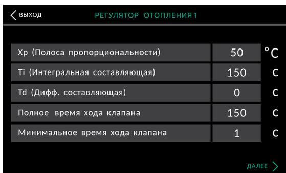
Рисунок 6.19 – Регулятор отопления, экран 1
