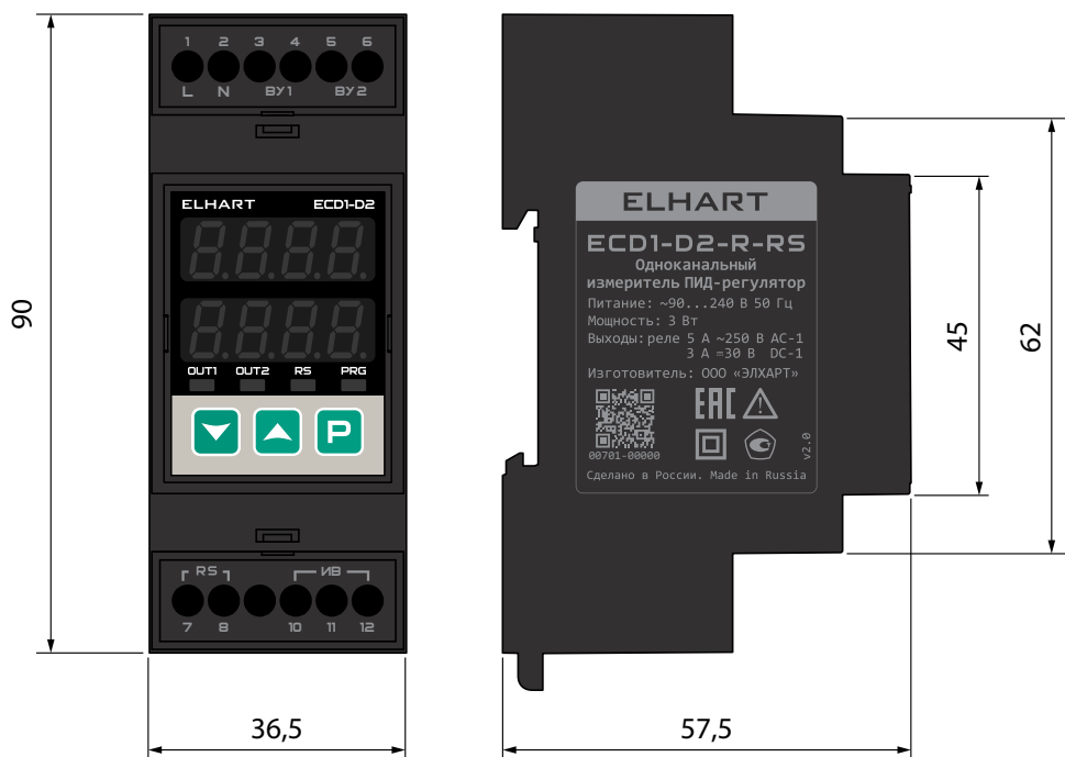
Рисунок 1 - Внешний вид и основные размеры прибора
