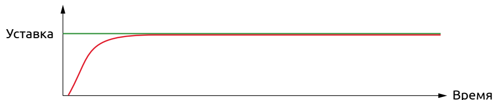
Рисунок 20 - Выход на уставку правильно настроенного ПИД-регулятора
