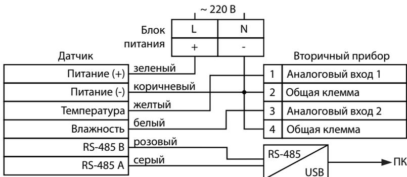
Рисунок 6 - Схема внешних электрических подключений датчиков HTE.PF-U10-RS
