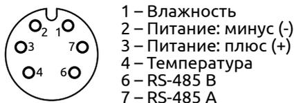
Рисунок 7 - Нумерация контактов разъема датчика HTE.PF-\*\*\*M-(RS)
