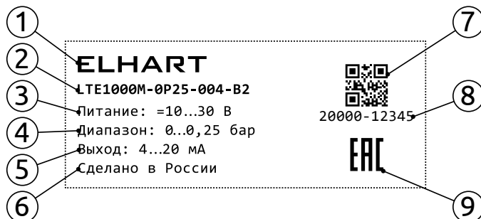
Рисунок 2 - Пример гравировки корпуса датчика
