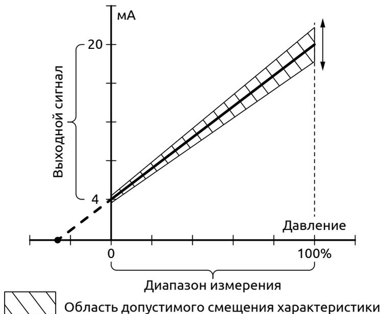
Рисунок 10 - Смещение характеристики выходного сигнала при изменении наклона
