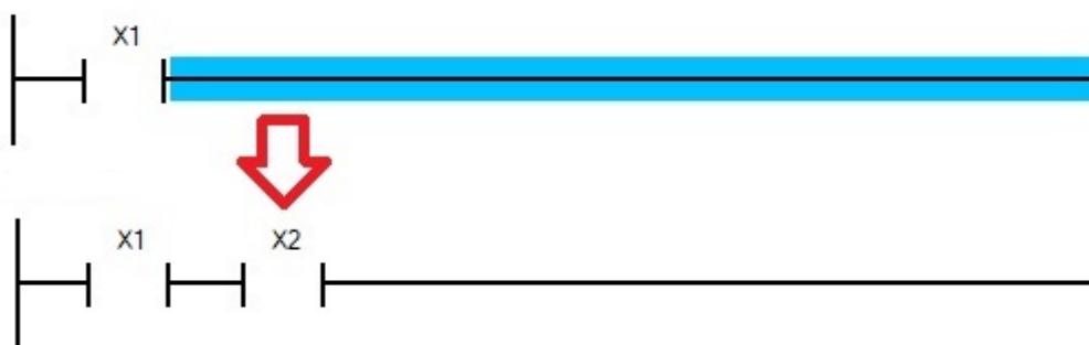
Установка элементов последовательно
