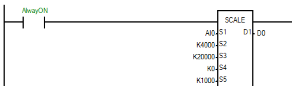
Преобразование сигнала от датчика с выходом 4...20мА в диапазон 0...1000
