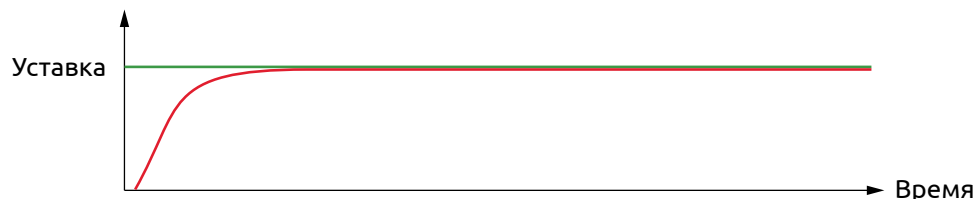
Рисунок 16 - Выход на уставку правильно настроенного ПИД-регулятора
