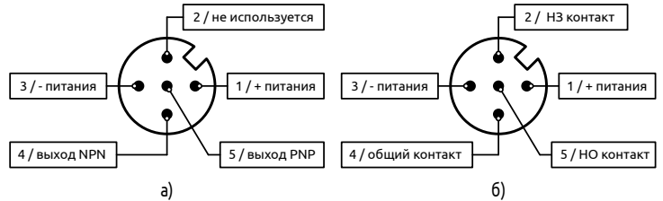
Рисунок 2 - Расположение контактов разъема M12 сигнализаторов ELS: а) исполнения ELS-XXX-T, ELS-XXX-TH и ELS-XXX-TM с транзисторным выходом; б) исполнения ELS-XXX-R, ELS-XXX-RH с релейным выходом
