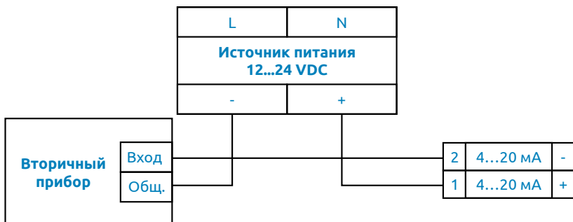
Рисунок 19 – Пассивный токовый выход
