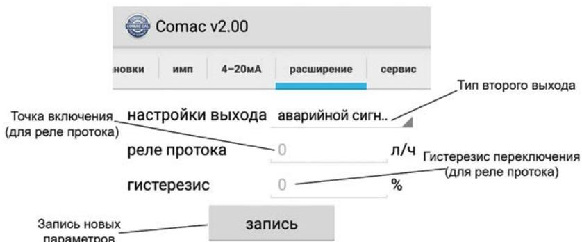
Рисунок 17 – Настройка импульсного выхода 2
