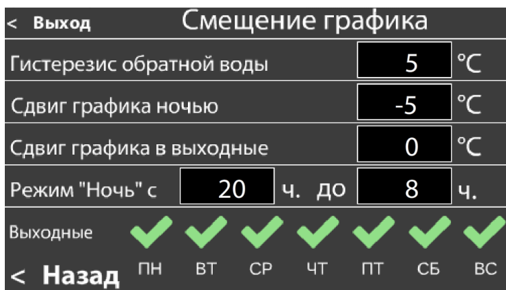
Рисунок 5.25 – Настройки графика отопления
