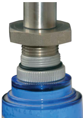
Рисунок 4 (Пример монтажа в эталон влажности датчика VR.D)
