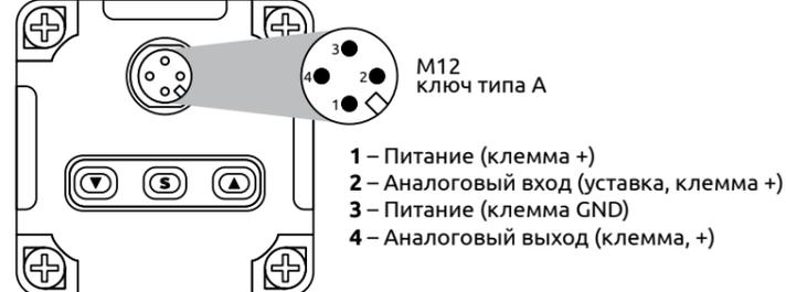
Величина сигнала на аналоговом выходе устройства пропорциональна текущему давлению на выходе EPR в процентах от рабочего давления, определённого модификацией устройства (см. п. 3 Модельный ряд). Настройки пользователя, включая значения минимального и максимального давления на выходе устройства, не изменяют диапазон давления относительно которого формируется значение выходного сигнала.
