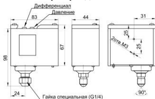
Рис.4 Габаритные и присоединительные размеры РД-2Р-0,8МПа-G1/2 (модель 35)
