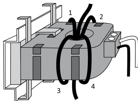
Рисунок 3 – Подключение с наматыванием нескольких витков
