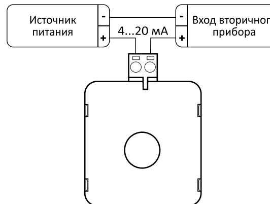
Рисунок 5 – Схема подключения токовой петли
