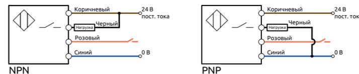
Рисунок 5 – Схема подключения фотоэлектрических датчиков
