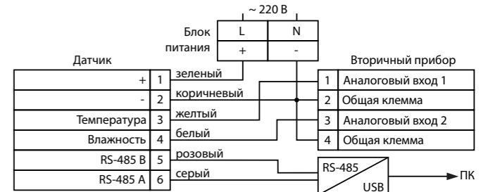
Рисунок 6 – Схема внешних электрических подключений датчиков НТЕ.РF-U...
