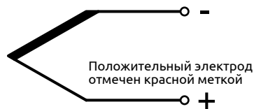
Рисунок 2 – Схемы соединения внутренних проводов преобразователя термоэлектрического ТСЕ.С34
