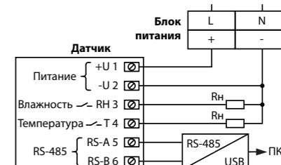
Рисунок 7 – Схема внешних электрических подключений датчиков HTE.VS-2T-RS
