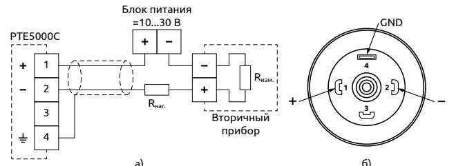
Рисунок 2 – Подключение электрических цепей датчика:
