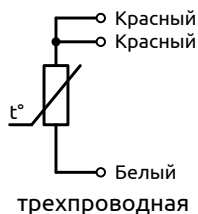
Рисунок 2 – Схемы соединения внутренних проводов термопреобразователя TRE.C41
