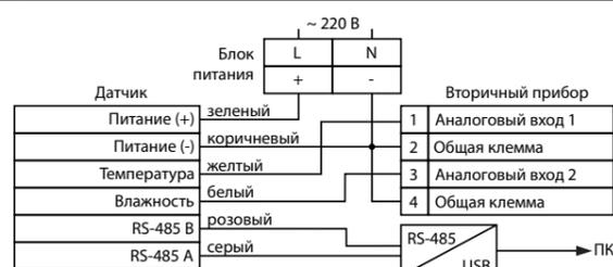
Рисунок 5 – Схема внешних электрических подключений датчиков HTE.PF-U10-RS
