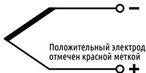
Рисунок 2 – Схемы соединения внутренних проводов преобразователя термоэлектрического TCE.C02
