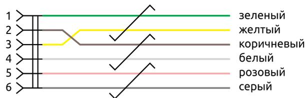
Рисунок 2 — Схема внутренних соединений кабеля HTE-Cable-xxx
