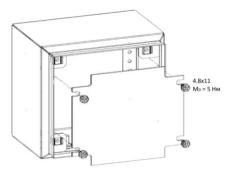
**Б.** Установка DIN-рейки в распределительные коробки глубиной 80 мм.
