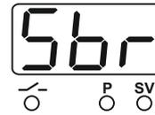
Sbr - сообщение о неисправности датчика. Неправильное подключение или обрыв.
