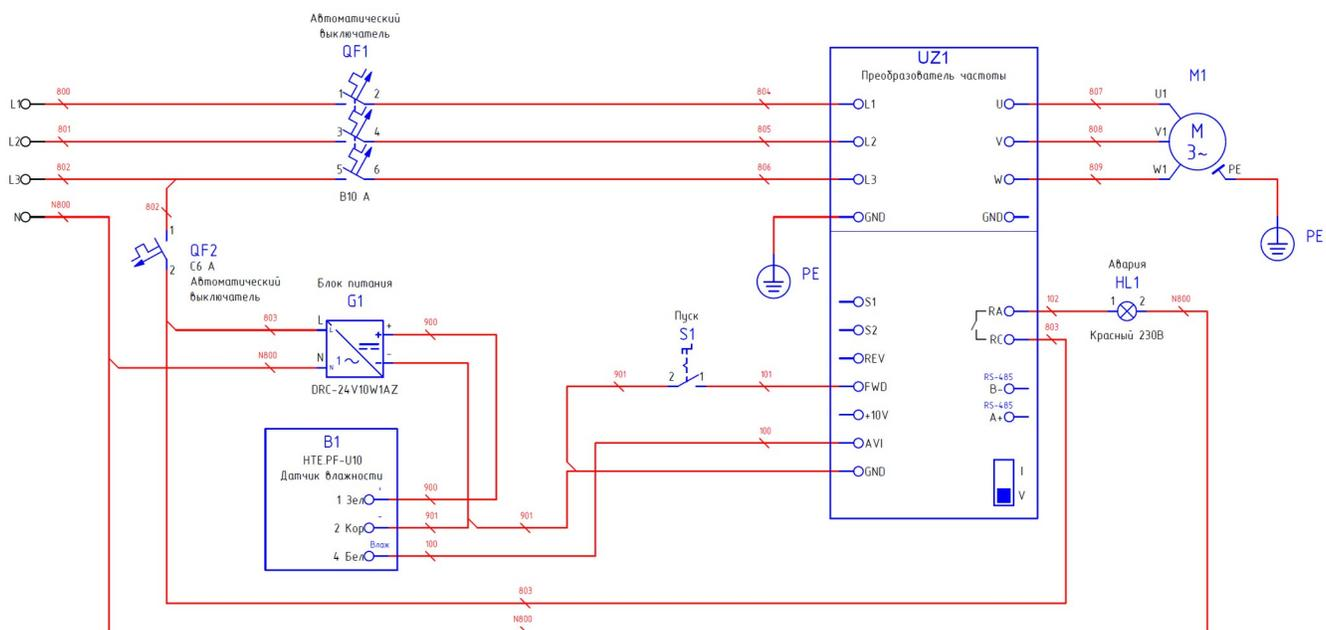
Рисунок 1 — Подключение ПЧ ELHART серии EMD-MINI
