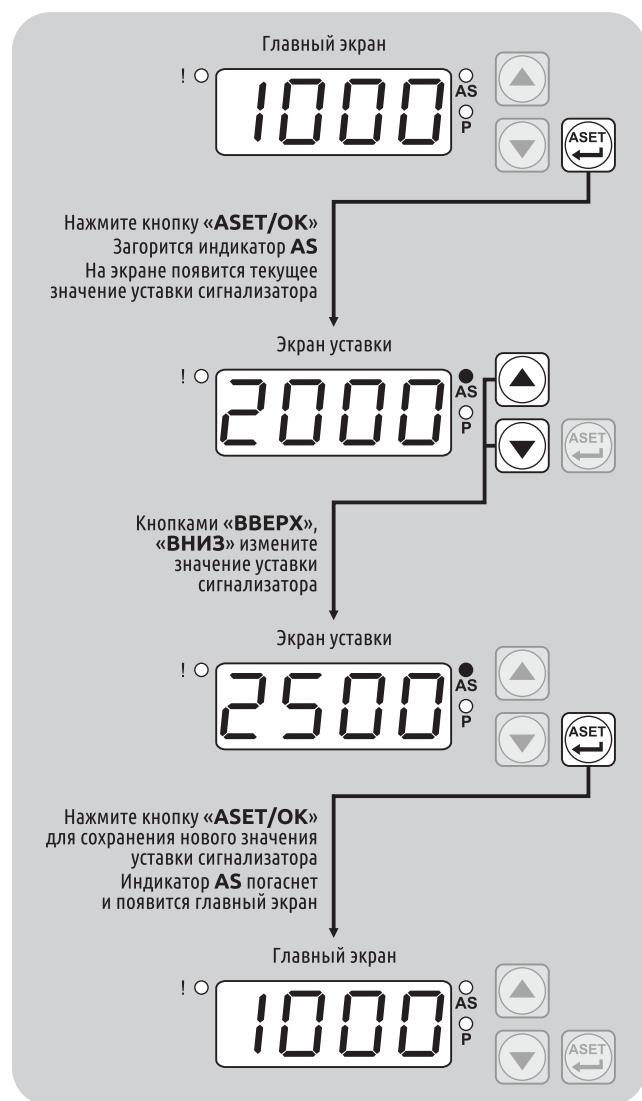
**Примечание 1:** Значение уставки сигнализатора может быть установлено в пределах диапазона измерения датчика ( $\text{EPoL} \dots \text{EPoH}$ ).
