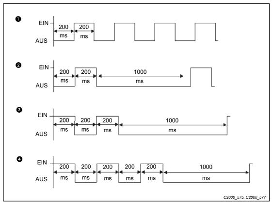
Fig. 10-2: Flashing of the CAN RUN und CAN ERR LED
