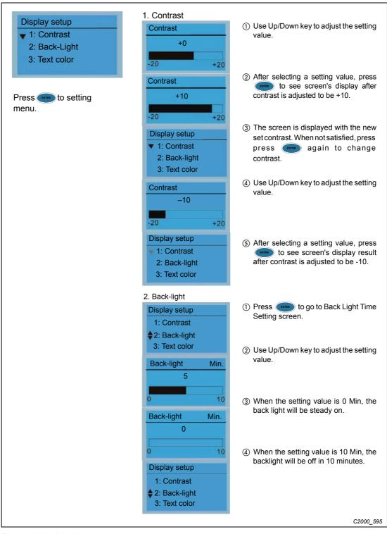
Fig. 10-18: Display setup
