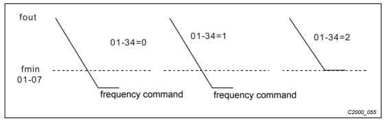
Fig. 12-24: Regelung der Stillstandsdrehzahl im FOCPG-Betrieb
