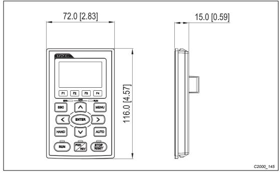
Fig. 1-29: Digital keypad KPC-CC01
