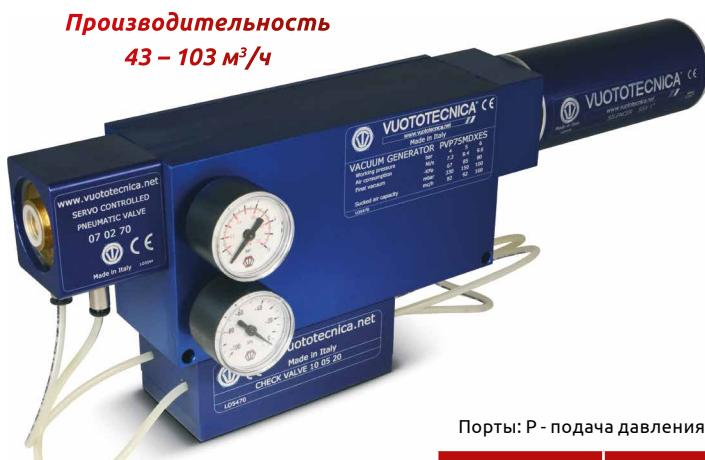
Многостадийные генераторы вакуума серии PVP 25÷75 MDX ES являются энергонезависимыми автоматическими устройствами, способными поддерживать уровень вакуума на определенном значении (при помощи пневматического реле давления) и при этом не требующие электрического напряжения питания. При достижении требуемого значения вакуума генератор не потребляет сжатый воздух благодаря встроенному пневмоклапану.
