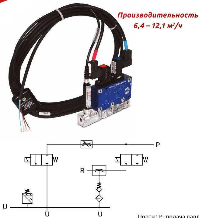
Многостадийные генераторы вакуума серии GVMM оборудованы настраиваемым электронным реле вакуума и двумя соленоидными мини-клапанами, благодаря чему данные генераторы могут работать в автоматическом режиме поддержания заданного значения вакуума. При этом, после достижения заданного значения генератор перестает потреблять сжатый воздух от компрессора благодаря закрытию подающего соленоидного клапана.
