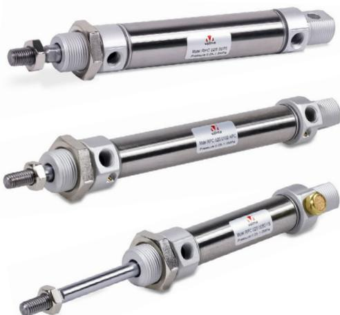
Пневмоцилиндры серии RPC соответствуют стандарту ISO 6432 и могут быть легко интегрированы как в новое, так и в уже используемое оборудование. Благодаря корпусу из нержавеющей стали данные цилиндры имеют достаточно жесткую конструкцию. Фиксация головок осуществляется с помощью завальцовки, что позволяет снизить итоговую стоимость изделия, но делает цилиндр необслуживаемым.
