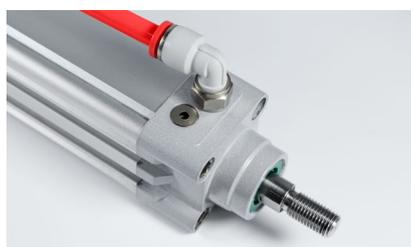
Регулируемое пневматическое демпфирование обеспечивает замедление в конце хода штока и предотвращает удары поршня о головки цилиндра. Настройка демпфирования осуществляется с помощью микрометрического винта в зависимости от инерции нагрузки пневмоцилиндра.
