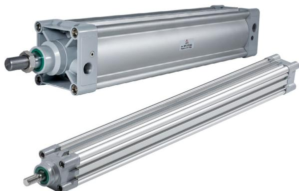
Корпус пневмоцилиндров SPC изготавливается из экструдированного алюминиевого профиля, что делает их более жестким по сравнению с цилиндрами, имеющими корпус из алюминиевой трубы. Уплотнения штока и поршня выполнены из полиуретана (PU), что значительно повышает срок службы данных пневмоцилиндров, а регулируемое пневматическое демпфирование позволяет настроить цилиндр под перемещаемый объект и избежать ударов в конце хода.
